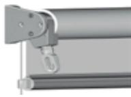
Guía de cable de acero US3910/1 con elementos de cierre roscados, apretados arriba y abajo, para la fijación en la tapa lateral arriba y en el soporte de fijación abajo.
